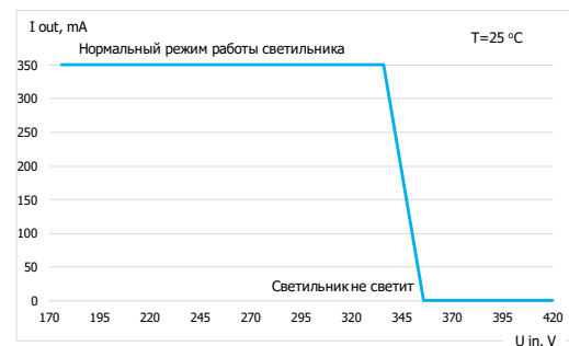
Рисунок 7 – Работа защиты от превышения входного напряжения при максимальной нагрузке и T_a = 25 °C
