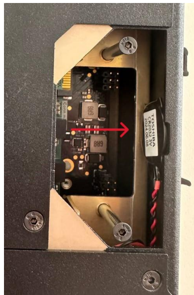
Рисунок 10 – Батарея питания внутри корпуса
